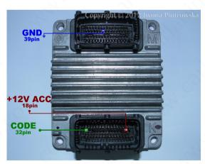
GND 39pin (socket - M) power 18pin (socket - K) CODE 32pin (socket - K)
